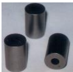
燃料コンパクト (外径: 26mm、高さ: 39mm)
