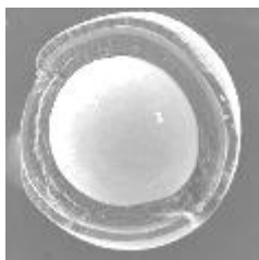
被覆燃料粒子 (直径: 920μm)
