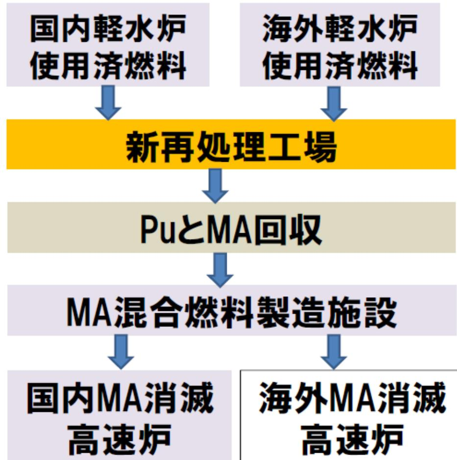
新再処理工場では、国内の軽水炉使用済み燃料
