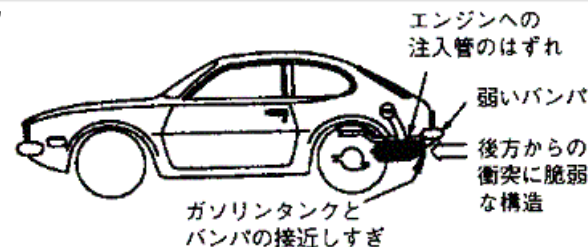
図1 1971年、1972年型フォード・ピントの構造欠陥
