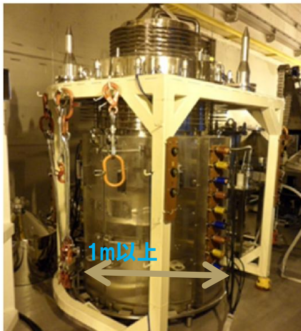
ウランを固体陰極に析出 する電解槽(50Kg/d:直径 は1m以上と推定)
