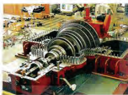
・蒸気タービン
