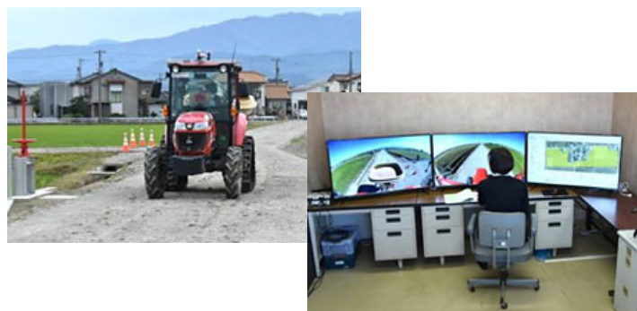
ほ場間移動を含む遠隔監視型 無人自動走行システム（農研機構）
