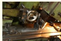
目立ての工程
