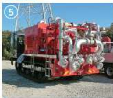
可搬型の注水ポンプ
