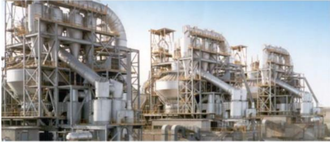
図3 DAC で用いる流動層鉱石焙焼炉 (Keith 氏講演資料より)
