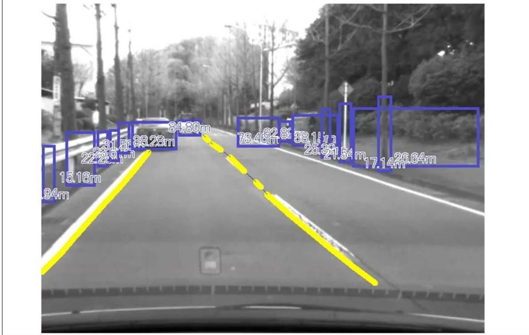
私が 10 年前に実施した時速 30~40 km の自動運転の映像であるが、結構認識できている。当時でも、この程度のコンピューターの処理能力はあったわけである。今では、このソフトは無料でダウンロードできる。IoT の時代となり、速く認識ができるようになり、自動運転、金融、消費行動分析などにも、このような技術が使われている。
