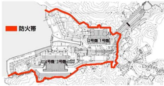
発電所を囲む幅1.8mの防火帯
