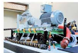
PWR可搬式代替低圧注入ポンプ
