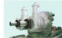
ガスタービン非常用発電機
