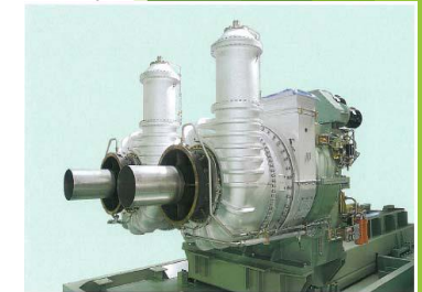
ガスタービン非常用発電機
