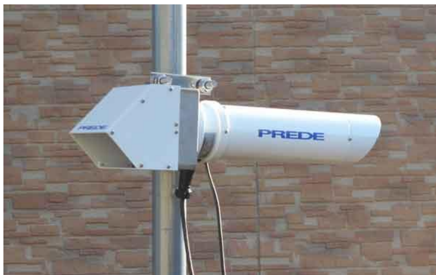
(図2) 通風筒（横型）の例。これを改良して現在、長期観測用の高精度通風筒（傾斜型）の製品1号器が完成し、最終試験中である。出典：近藤純正ホームページ K146 図 146.3 http://www.asahi-net.or.jp/~rk7j-kndu/kenkyu/ke146.html
